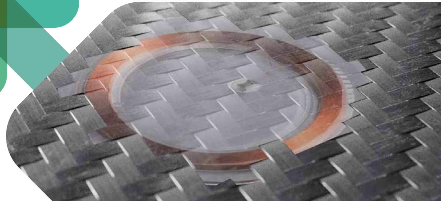
In Carbon-Fasern eingearbeiteter NFC-Transponder für Seriennummern, Identifikation etc.
