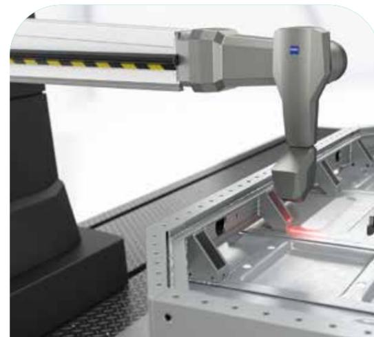
Taktile Messung einer Batterie-wanne an einem Horizontalarm-KMG von ZEISS
