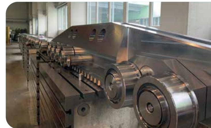
Kompetenzdemonstration: HELDECO hat 40 Meter lange Zahnstangen für den Einsatz in der Stahlindustrie bearbeitet. (© HELDECO)
