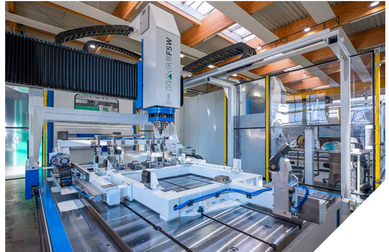
FSW Anlage für die Herstellung der Batterieboden
