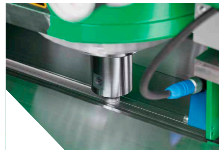
Detail einer Rührreißschweißanlage von HAGE
