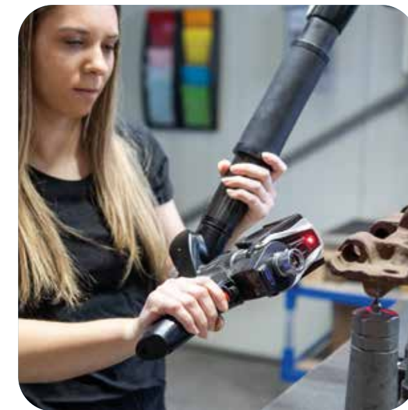
Mit modernen Lasermessgeräten wurden die alten Kettenglieder vermessen. Auf Basis des virtuellen Abbilds wurden über 300 neue erzeugt. © x-technik/Pelozo
