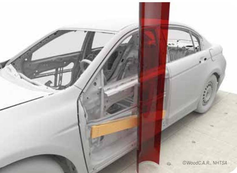
Der entwickelte Seitenaufprallträger bei der Crash-Simulation
