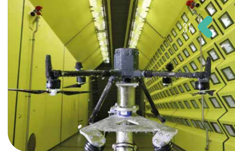
Testflug im Eiswindkanal für das Projekt „IceDrone“
