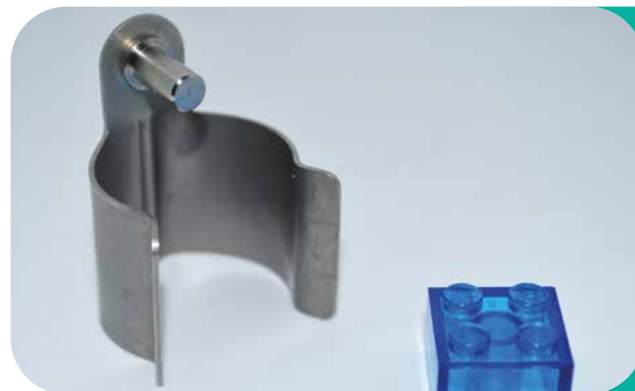
Tie Rods (Befestigungselemente) verbaut in Flugzeugen
