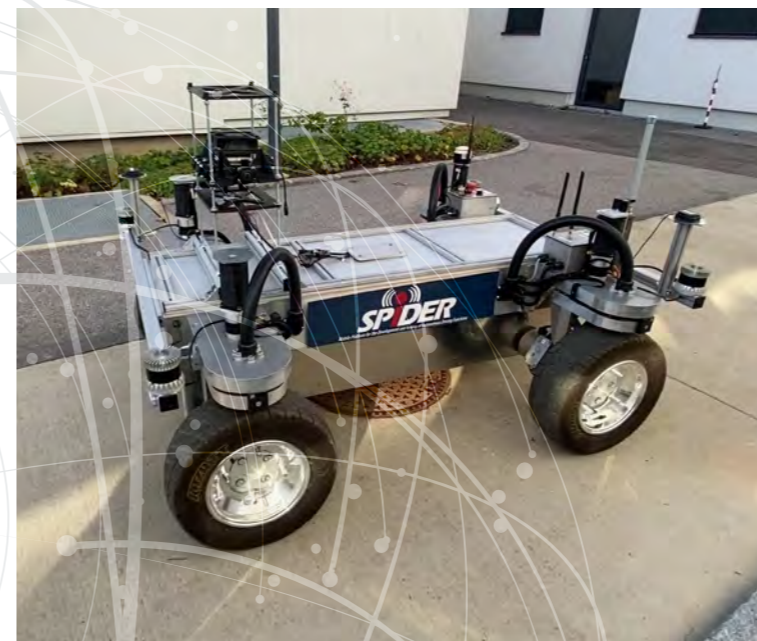
SPIDER im automatisierten Einsatz mit intelligentem 360° Kamerasystem von Mission Embedded
