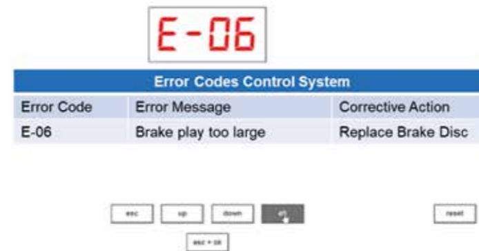
Bild 1: kontextsensitive Abhilfe für einen Fehlerzustand
