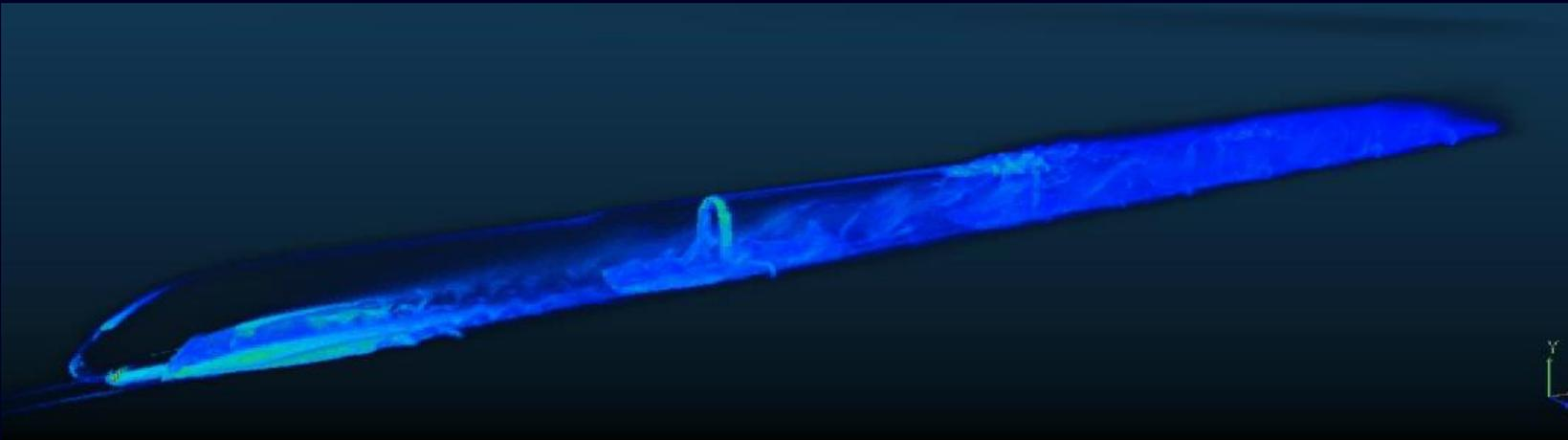
Visualisierung der Strömungsverluste an einem Hochgeschwindigkeitszug
