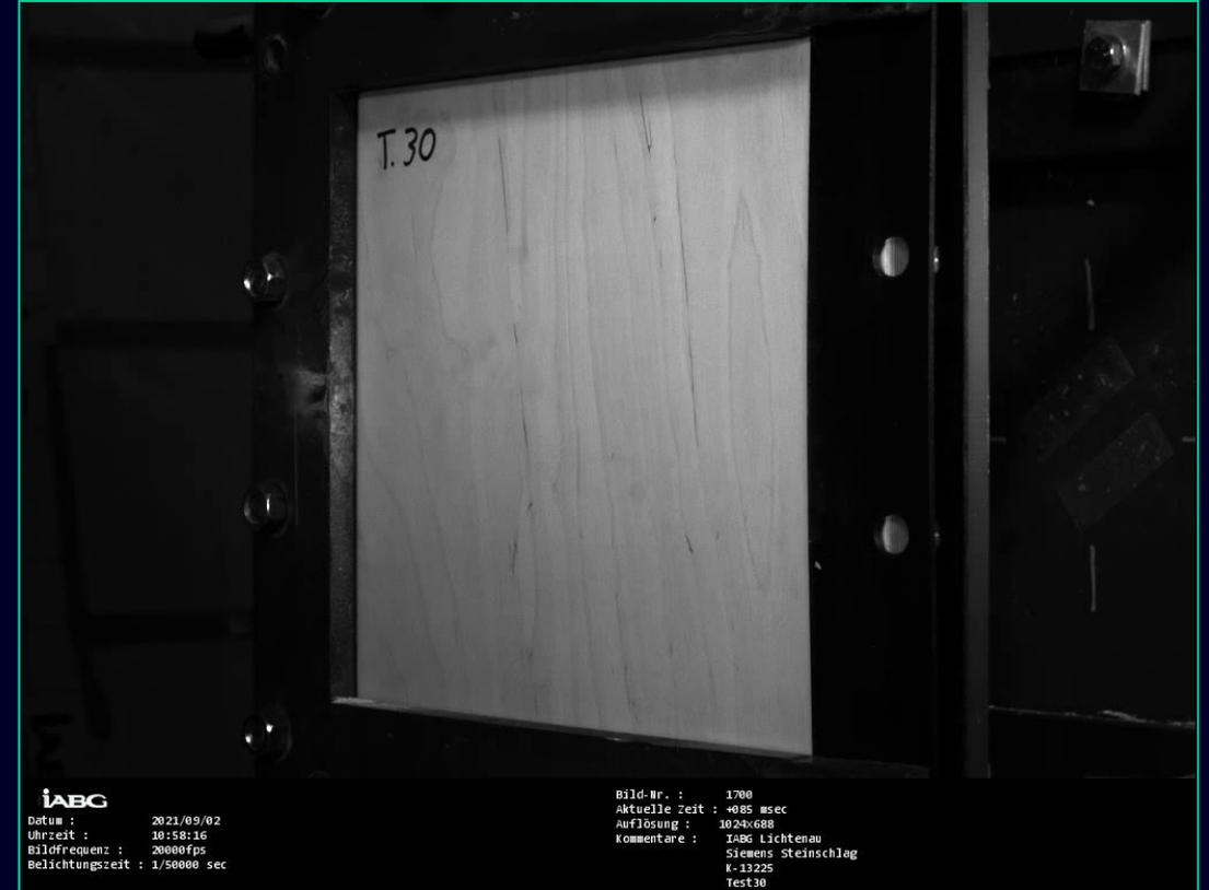
Beschussversuche mit 200 mm Granitkugel zeigen hohe Widerstandsfähigkeit gegen Durchdringen des Werkstoffs (z.B. Probe T.30 bei 657 km/h bei 15° Beschuss- Winkel)
